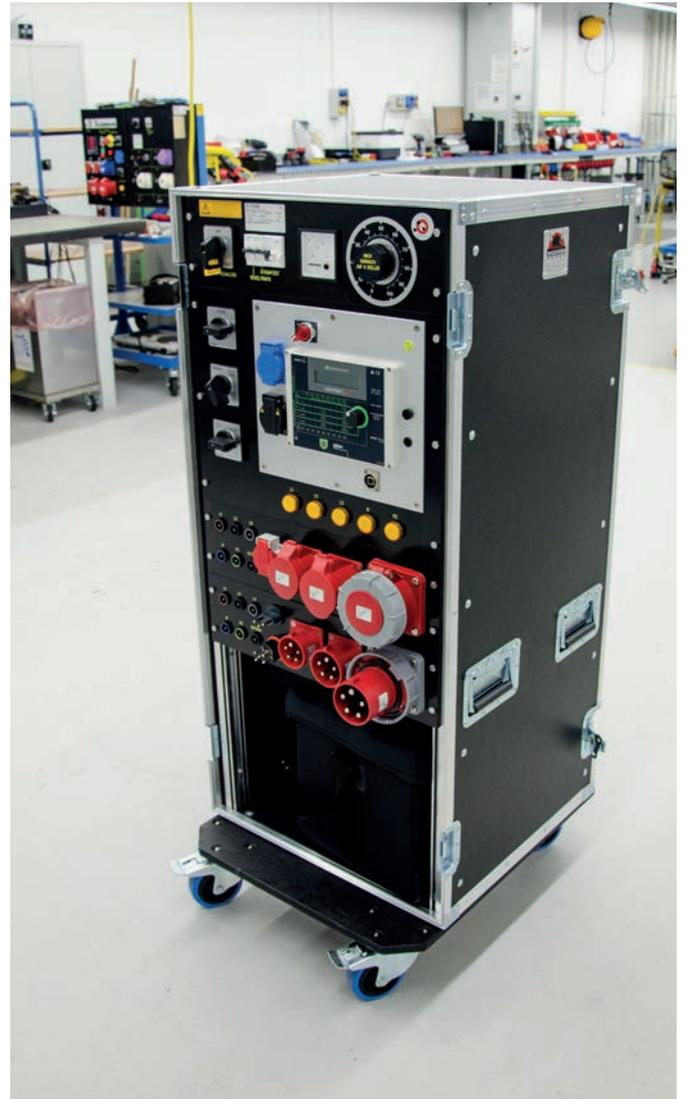
Apparecchio di prova per elettricità e lampadine
