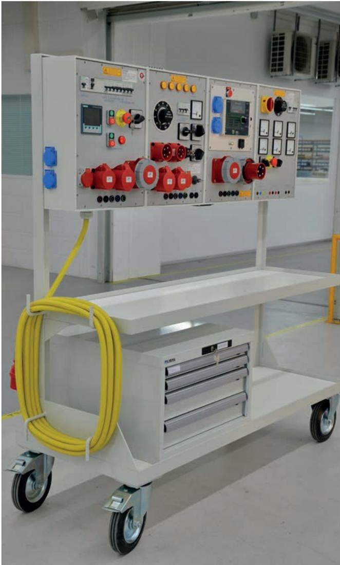
Unità base apparecchio di prova, apparecchio di prova per cavi e gruppo di corrente AC/DC – montata all'interno di tavolo da lavoro mobile con cassetti
